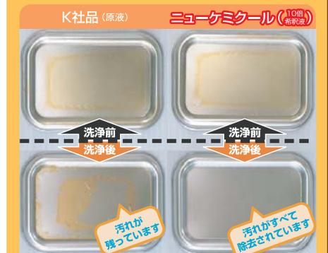
試験条件：10倍に希釈した溶液に油汚れの試料板を10分間浸漬し、引き上げた。
